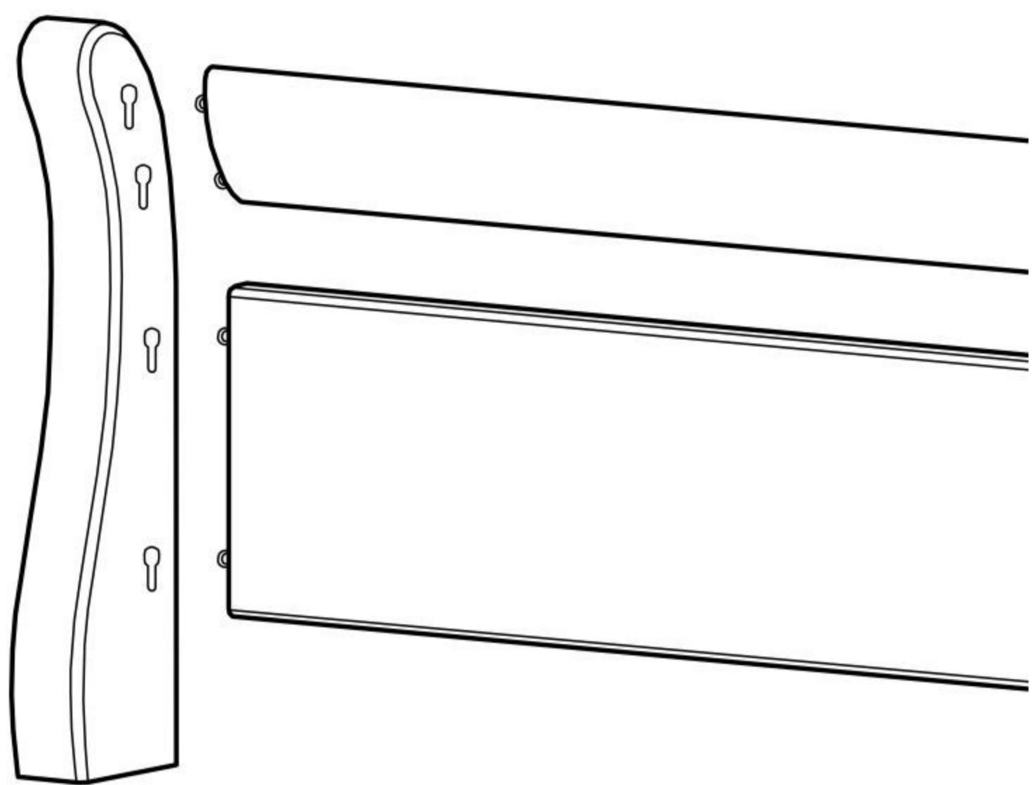
Для складання деталей використовується клиноподібне з'єднання. Потрібно вставити одну деталь в іншу, та з силою натиснути на торець вниз до упору і деталі зібрані. Якщо Вам здається, що деталі стяглися між собою недостатньо щільно, потрібно підтягнути гвинти хрестоподібної викруткою на потрібну відстань, та повторити спробу.
