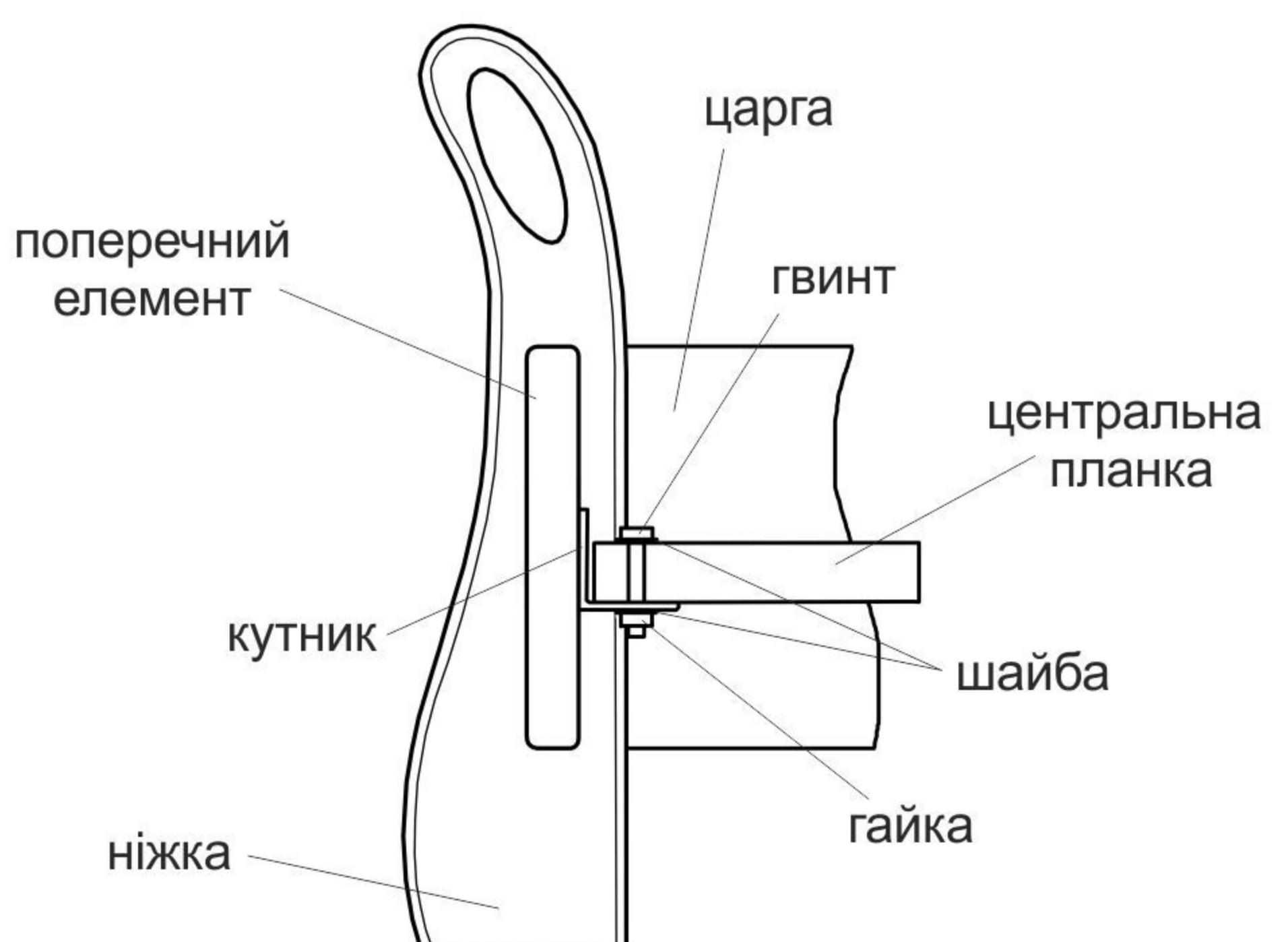
Встановіть центральну планку на кутники та з'єднайте їх між собою використовуючи гвинт, шайби та гайку, як показано на малюнку.
